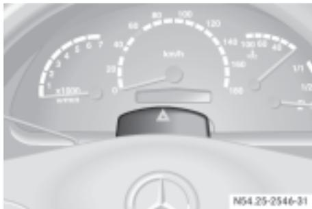
Кнопка аварийной световой сигнализации
